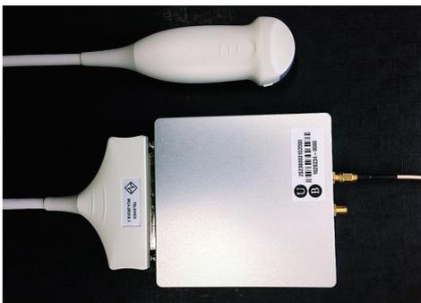
Figura 1: Ecógrafo de bolsillo de Telemed y sonda.
